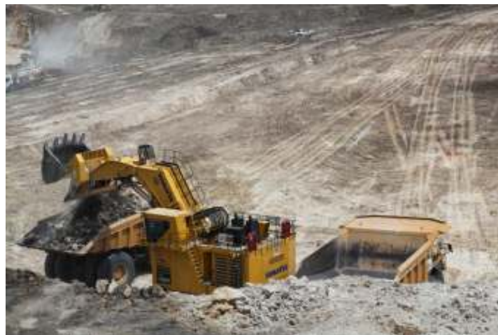
Alat berat baru yang dioperasikan oleh SIS: pemuatan dua sisi sebesar 400 ton hydraulic excavator PC4000 ke 200 tonnes overburden trucks Cat 789
